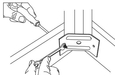
Rohový spoj dotahujeme pomocí klíče tak, aby byla hlava vrutu po dotažení zapuštěna v materiálu. Šroubovák slouží k přichycení vrutu proti otočení. Vruty zakryjeme krytkami.
