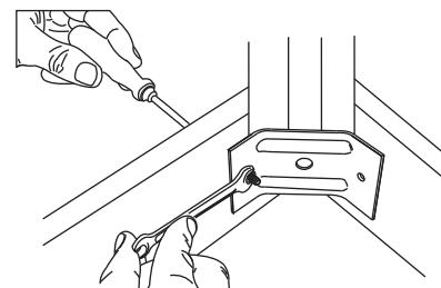
Rohový spoj dotahujeme pomocí klíče tak, aby byla hlava vrutu po dotažení zapuštěna v materiálu. Šroubovák slouží k přichycení vrutu proti otočení. Vruty zakryjeme krytkami.
