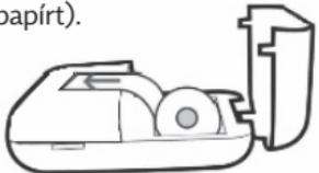
2. Zárja be a papírtálcát. A készülék automatikusan feltekeri a papírt.
