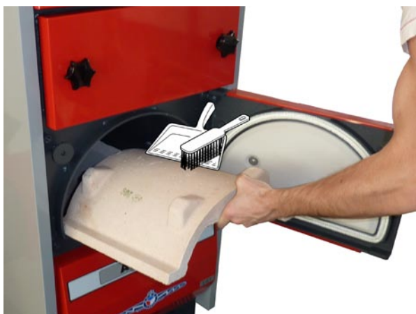
Čištění keramického spalovacího prostoru - klobouku
