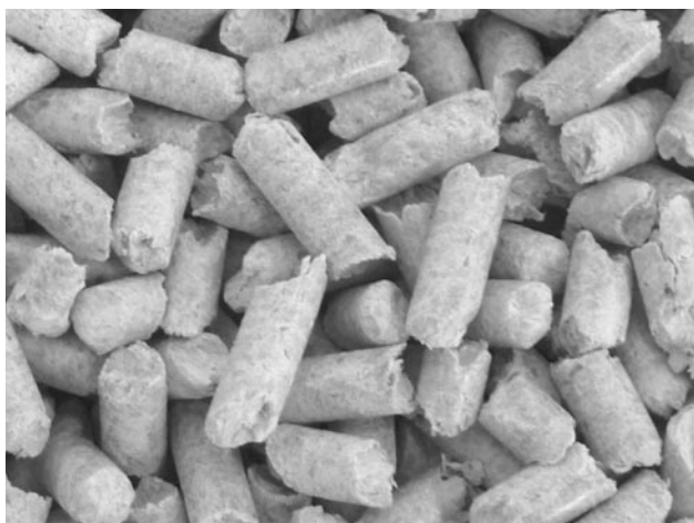
Kvalitní dřevěné pelety - bílé bez černých teček (kůry)
