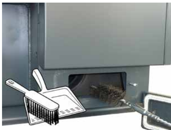
Ukázka čištění kouřového kanálu - spodní víčko
