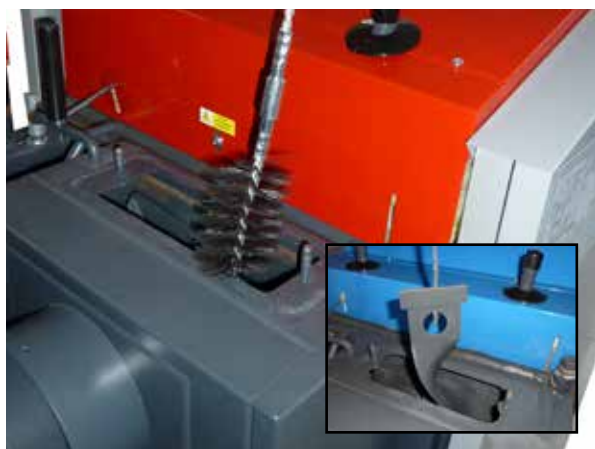
Ukázka čištění kouřového kanálu drátěným kartáčem - vrchní víčko Při čištění vyndejte brzdiče (turbulátory) z kouřového kanálu
