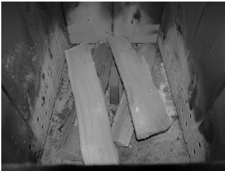
Obr. 7 Základní vrstva dřeva při roztápní
