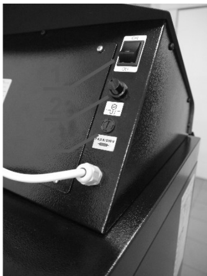
Obr. 17 1 – hlavní vypínač, 2 – havarijní termostat, 3 – pojistka (F6,3A)
