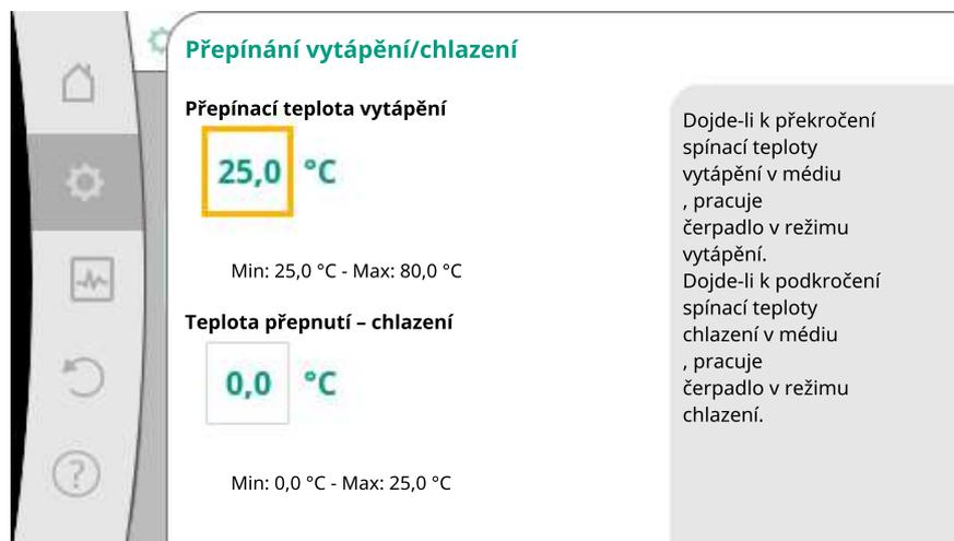
Fig. 57: Přepínání vytápění/chlazení\_ teploty přepnutí
