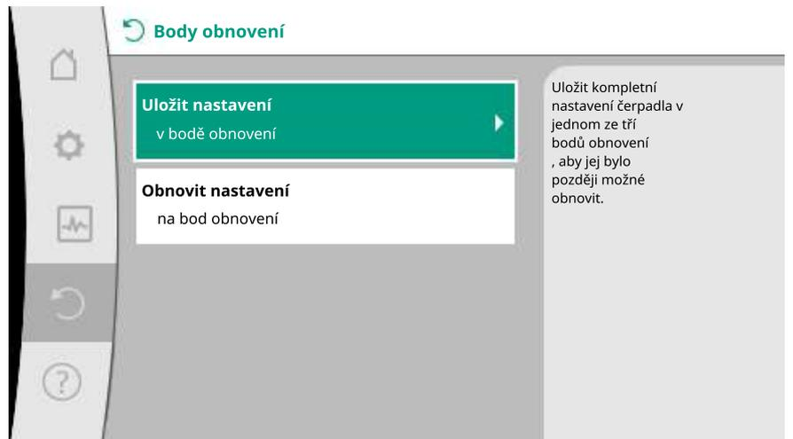
Fig. 84: Body obnovení – Uložit nastavení
