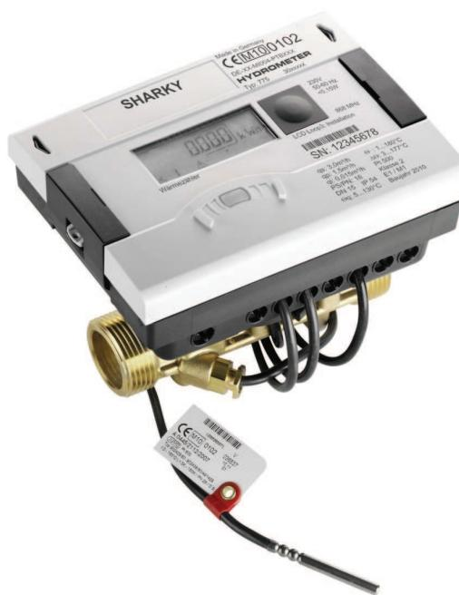
**Kompaktní měřič tepla a chladu s ultrazvukovou průtokoměrnou částí pro nominální průtoky 0,6 - 100 m<sup>3</sup>/h, PN25 a maximální teploty až do 150°C.**
