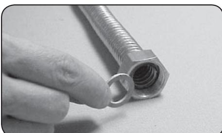
Vložte ploché těsnění a zkontrolujte správnou polohu svíracího měsíčku.
