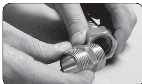
Do převlečné matice zašroubujte vhodné šroubení (např. šroubení s vnějším závitem nebo šroubení se svěrným spojem).
