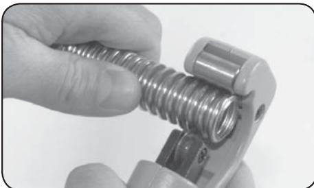
Pomocí rezáku trubek uřízněte vlnitou trubku na požadovaném místě.
