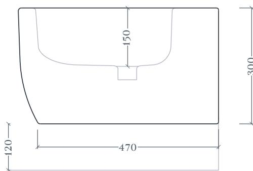
N.B. Le misure indicate possono subire una variazione dell'0,6% circa, dovuta ad usura stampi e variazioni delle caratteristiche tecniche relative alle materie prime che compongono l'impasto .
