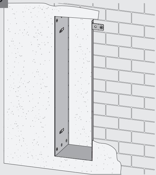
**montage** - einbaurahmen in mauerwerk · installation frame in masonry ·
