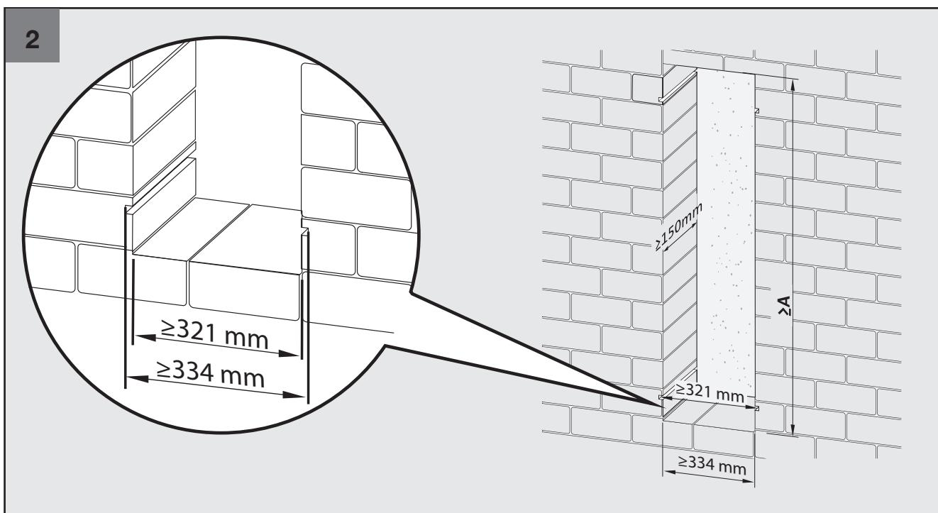
**montage** - einbaurahmen in mauerwerk · installation frame in masonry ·
