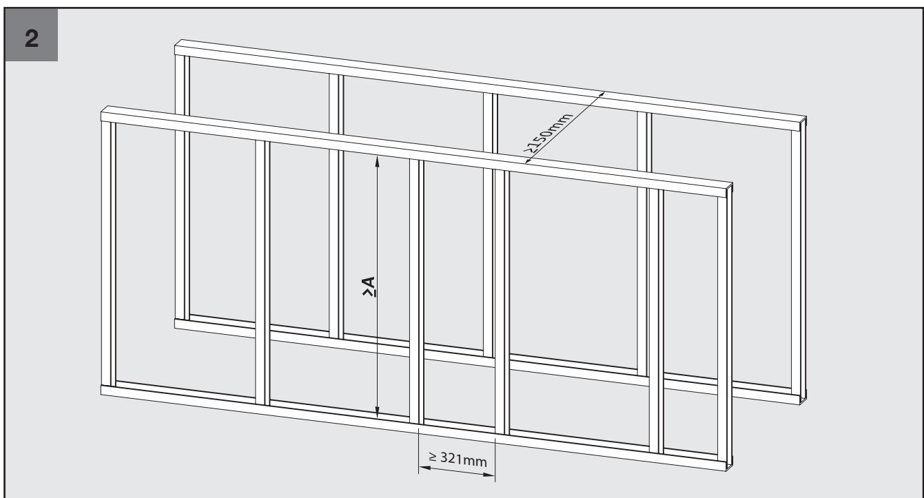
**montage** - einbaurahmen in metall-ständerwerk · installation frame in metal frame work ·
