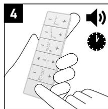
4 > Нажмите "Стоп", чтобы остановить функцию очистки или подождите 2 мин. до автоматического отключения.
