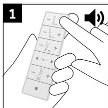
1 > Nacisnąć przycisk Plus, aby zwiększyć natężenie strumienia w myciu tylnym.
