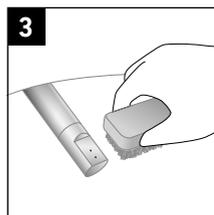
3 > Oczyszczyć dyszę ścierką, gąbką lub szczotką oraz łagodnie działającym środkiem czyszczącym.
