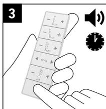
3 > Stisknutím tlačítka Stop ukončete čištění. Jinak bude automaticky ukončeno po 90 sekundách.
