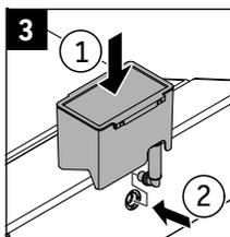
> Spremnik postavite na kućište te crijevo u potpunosti umetnite u otvor.
