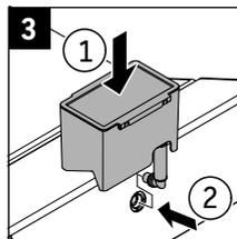
> Postavite rezervoar na ohišje in vstavite gibljivo cev do konca v odprtino.
