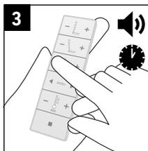
3 > Нажмите Минус, чтобы остановить функцию «Комфортный душ». Ранее установленная функция (душ для ягодиц или душ для дам) по-прежнему активна. Автоматическое отключение происходит через 2 мин.
