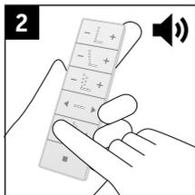
2 > Stisknutím tlačítka Minus snížíte teplotu vody.
