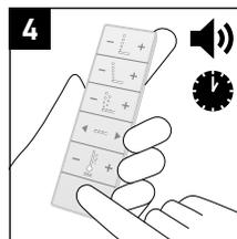
4 > Ukončete čištění stisknutím tlačítka Stop. Jinak bude automaticky ukončeno po 2 minutách.
