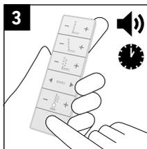
> Pritisnite tipku Stop da zaustavite čišćenje ili pričekajte da se automatski zaustavi nakon 90 sekundi.
