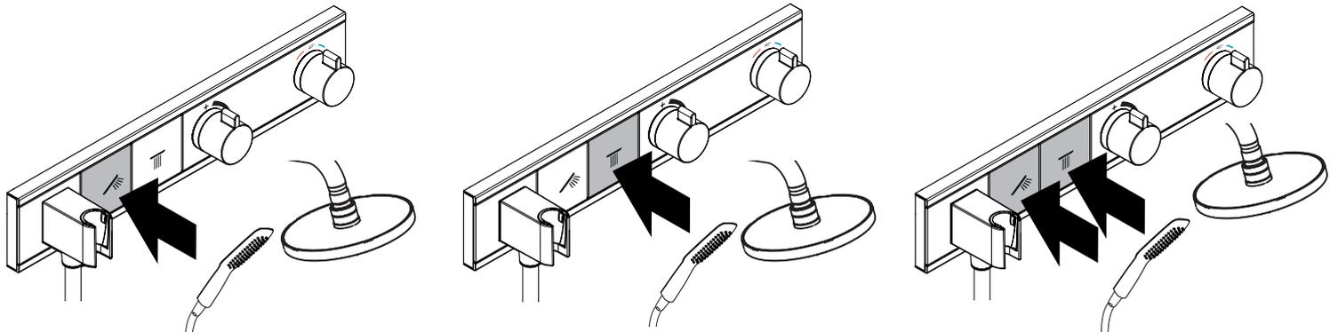
schließen / fermé / close / chiudere / cerrar / sluiten / lukke / fechar / zamknąć / zavřít / uzavrieť / 关 / закрыть / bezárás / sulkeminen / stänga / uždaryti / Zatvaranje / karatmak / ίnchide / κλειστό / zapreti / sulgege / aizvērt / zatvori / lukke / затваряње / mbylle / إغلاق / 閉じる
