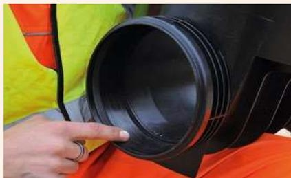
Před montáží proveďte kontrolu všech dílů šachty a přesvědčte se, zda jsou těsnění správně umístěna v drážkách.
