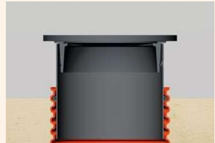
Do šachtové roury zasuňte teleskopickou rouru s poklopem. Ve spoji použijte těsnění k teleskopu, které je třeba umístit zevnitř šachtové roury do horní vlny.
