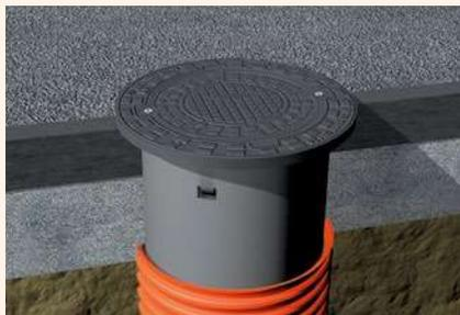
Zopakujte všechny předchozí činnosti (odkryt poklop, sejmout plech, vysunout poklop nahoru, zasypat prohlubeň, pečlivě vyčistit průlez, provést válcování).
