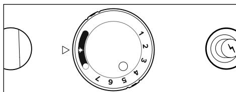
Nacisnąć do oporu przycisk B i przytrzymać; następnie nacisnąć zapalnik piezoelektryczny C.
