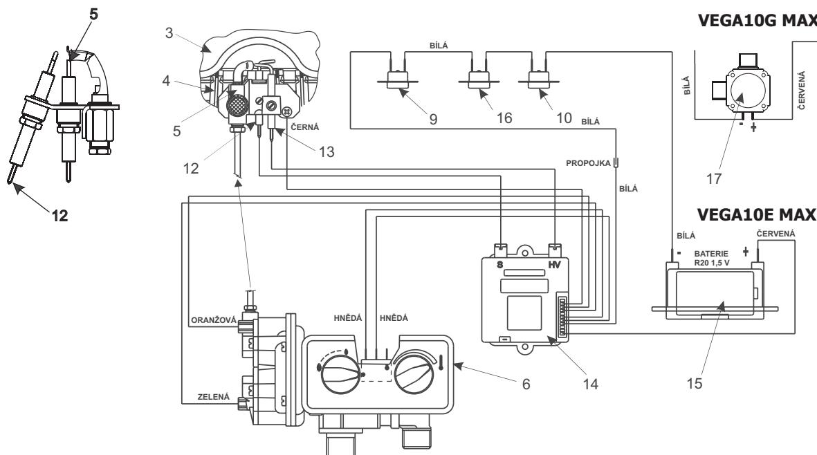
Hlavní funkční sestavu ohřívače tvoří celek vzniklý spojením kompaktní víceúčelové vodní a plynové armatury, hlavního plynového hořáku a zapalovacího hořáku. Nad hlavním hořákem je umístěn výměník tepla, zabezpečující předání tepla obsaženého ve spalinách do protékající vody.
