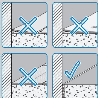
Alte Bodenbeläge Linoleum, Teppich, Laminat sind rückstandslos zu beseitigen (z.B. durch Schleifen).
