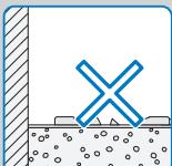
Der Untergrund muss fest, tragfähig, sauber, frei von trennenden Substanzen und trocken sein. Wachsschichten, Fett- oder Ölflecken sowie Sinterschichten, Bitumen und abgenutzte Oberflächen sind mechanisch zu entfernen. (Herstellerangaben beachten!)
