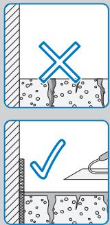
Die Lastverteilsschicht ist zu prüfen, Risse sind fachgerecht zu sanieren.
