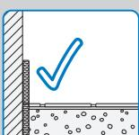
Der Untergrund muss trocken, fest, tragfähig, griffig und trennmittelfrei sein. Holzdielen müssen gut auf der Balkenlage befestigt und in Nut und Feder gefügt sein. Sie dürfen sich nicht gegeneinander bewegen, nicht federn und sind gegebenenfalls nachzuschrauben. Geeignete Spachtelmassen verwenden. (Herstellerangaben beachten!)
