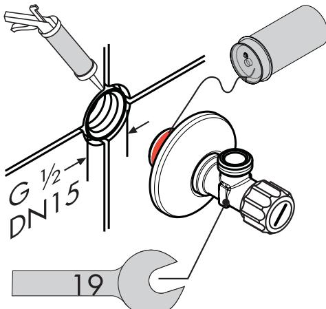
**DE Achtung!** Die beigegebenen Eckventile müssen montiert werden um Schmutzeinspülungen aus dem Leitungsnetz zu vermeiden. Schmutzeinspülungen können die Funktion beeinträchtigen und / oder zu Beschädigungen an Funktionsteilen der Armatur führen. Hieraus ergebende Schäden unterliegen nicht unserer Gewährleistung!
