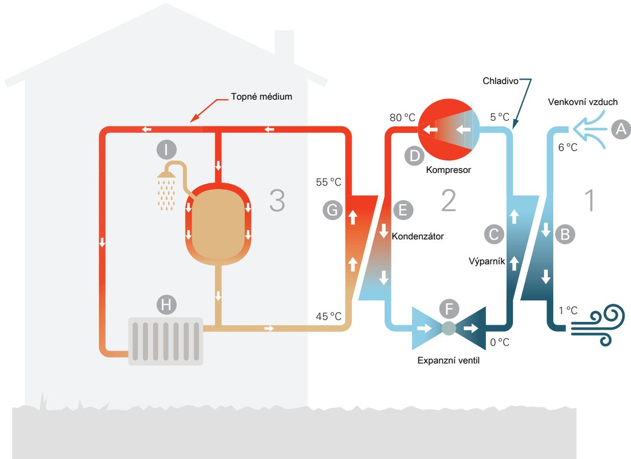
Uvedené teploty jsou pouze příklady a v různých instalacích a ročních dobách se mohou lišit.
