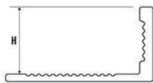
Ukončovací profil tvaru „L“ masiv elox kartáčovaný
