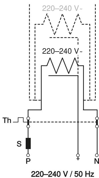
Para desconectar la calefacción en las estaciones cálidas se debe utilizar un termostato con sensor de temperatura exterior.
