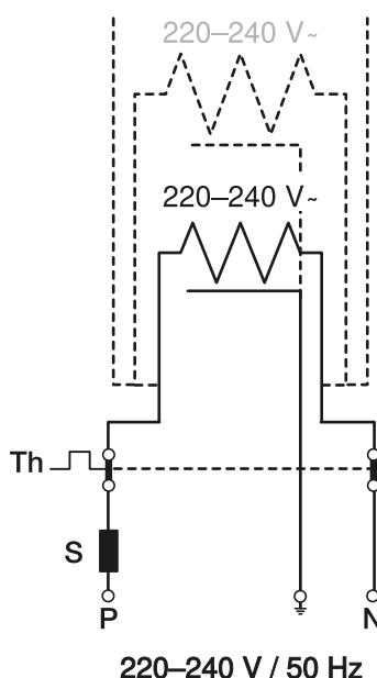
Pro účely vypnutí vytápěcího tělesa v teplém ročním období je třeba použít termostat se senzorem venkovní teploty.
