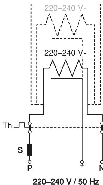
När värmeelementet ska stängas av under varma årstider ska en termostat med utegivare användas.
