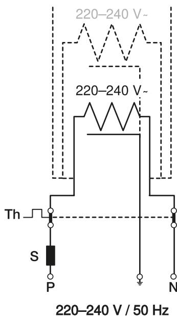
Pentru oprirea elementului de încălzire pe perioada anotimpurilor calde, trebuie să se utilizeze un termostat cu senzor de temperatură exterioară.
