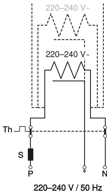
Per la disattivazione del riscaldamento nelle stazioni calde, utilizzare un termostato con sensore di temperatura esterna.
