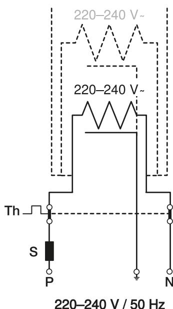
Isıtıcıyı yılın sıcak dönemlerinde kapatmak için dış sensörlü termostat kullanılmalıdır.
