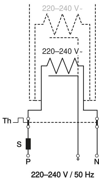
За изключването на нагревателя през топлите сезони трябва да се използва термостат със сензор за външна температура.
