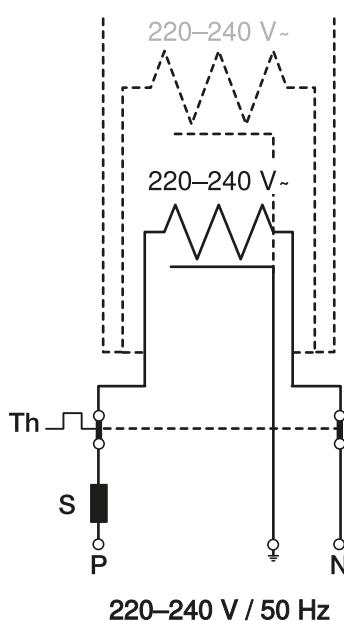
Za izklop gelnega elementa v toplejših letnih časih uporabite termostat s senzorjem zunanjne temperature.
