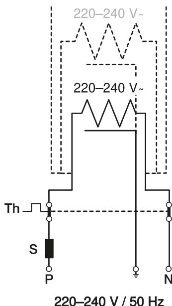
如要在气候暖和的季节关闭加热器，必须使用带外部传感器的温控器。
