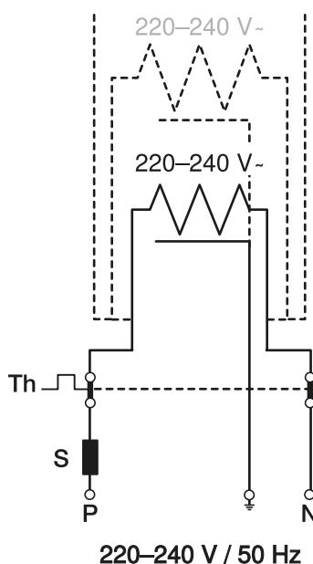
Lämpiminä vuodenaikoina lämmityselementin poiskytkentää varten on käytettävä ulkoanturilla varustettua termostaattia.
