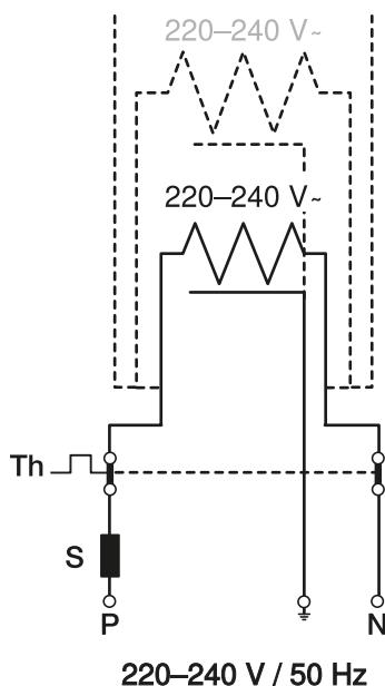
Za isključivanje grijanja u toplim godišnjim dobima mora se upotrijebiti termostat sa senzorom vanjske temperature.
