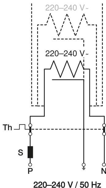
Для отключения нагревательного элемента в теплое время года следует использовать термостат с датчиком наружной температуры.
