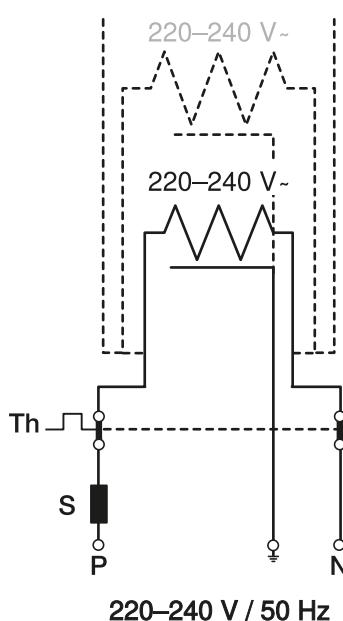
Para desligar o aquecimento nas épocas mais quentes do ano, deve utilizar-se um termóstato com sensor externo.
