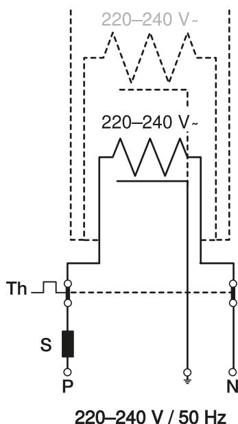
Pour mettre hors service le chauffage pendant les périodes chaudes de l'année, il faut utiliser un thermostat avec sonde extérieure.
