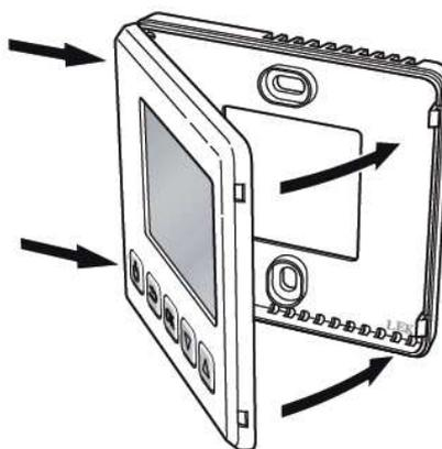
Umístěte přední panel pod úhlem cca 30° k zadnímu panelu a zacvakněte do klipů. Potom jednotku zavřete a zajistěte klipy na druhé straně (viz obr.).
