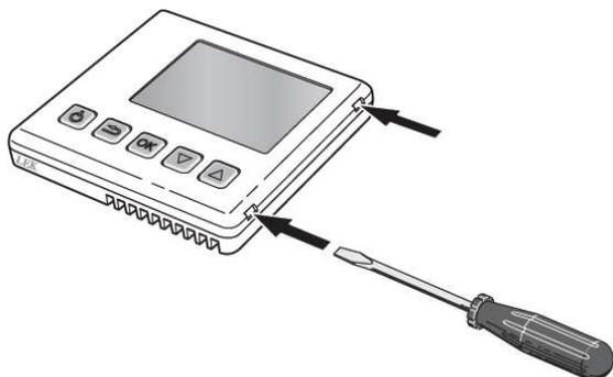
Otevřete RMU40 zatlačením šroubováku na plastové západky ve 4mm otvorech na hraně RMU40. Šroubovák zatlačte přímo na plastový klip (viz obr.) Postup opakujte pro ostatní 3 klipy.
