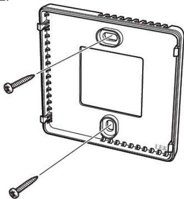
Při instalaci do zadržené el. přístrojové krabice – položte zadní panel na el. krabici a přichyťte dvěma šrouby.
