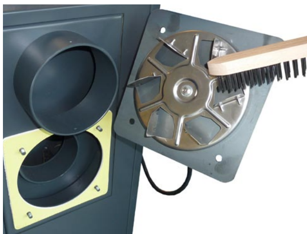
Ukázka čištění oběžného kola a kontrola kolmosti lopatek odtahového ventilátoru (u kotle D31P)
