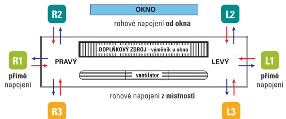
**V případě že provedení připojení (pravé/levé; přímé/rohové) nebude definováno, konvektor se dodá v provedení připravený pro připojení PRAVÉ PŘÍMÉ.**
