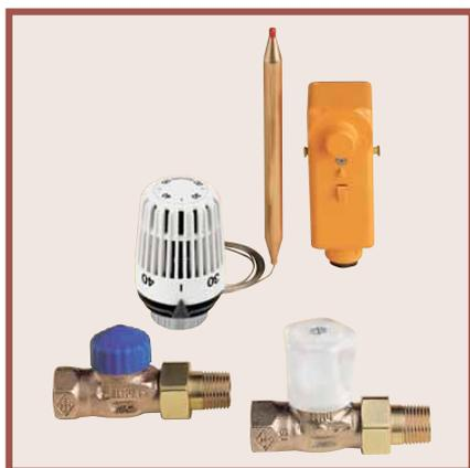
Podlahová regulační sada pro regulaci teploty přívodní teplotnosné látky je vhodná zejména pro regulaci okruhů podlahového vytápění v kombinovaných topných systémech s otopnými tělesy, dimenzovanými na vyšší než pro podlahové vytápění přípustný teplotní spád (např. 75/55 °C).
