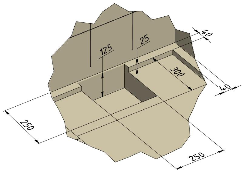
stavební připravenost \* construction preparation \* Aufbau-Vorbereitung \*
