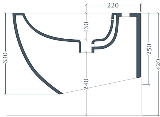
N.B. Le misure indicate possono subire una variazione dell'0,6% circa, dovuta ad usura stampi e a variazioni delle caratteristiche tecniche relative alle materie prime che compongono l'impasto.
