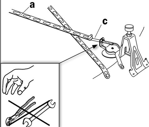
**4. Wanne umdrehen, ausrichten und Kontermutter (d) anziehen.**
