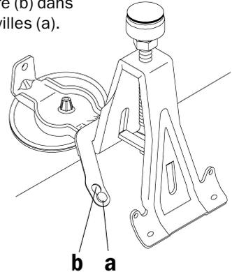
**3. Das Spannband mit passender Länge auf den Haltebolzen (a) schieben, den Gewindehaken (c) einhängen und mit der Mutter am Fuß handfest anziehen.**
