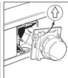
Dálkové ovládání je možno instalovat na stěnu na podomítkovou krabici, nebo na kryt trubkového kanálu.
