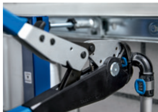
Ruční kleště pokrývají pět průměrů a nepotřebují elektrinu ani nabitě baterie.
