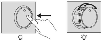
Za vklop luči pritisnite gumb in ga sprostite, da izstopi iz ležišča.
