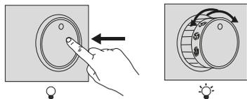
**Lumină** Pentru a aprinde luminile, împingeți butonul rotativ și eliberați-l astfel încât să iasă din locașul său.
