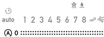
Los mandos de las zonas de cocción, del extractor y del temporizador se pueden activar pulsando el dígito de referencia.
