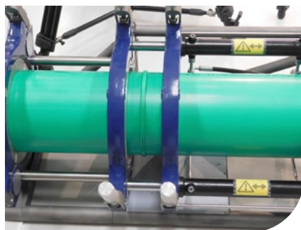
Svaření a chladnutí spoje
