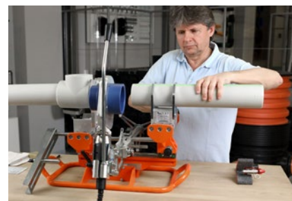
Upnutí do přípravku a vycentrování, poté nahřívání
