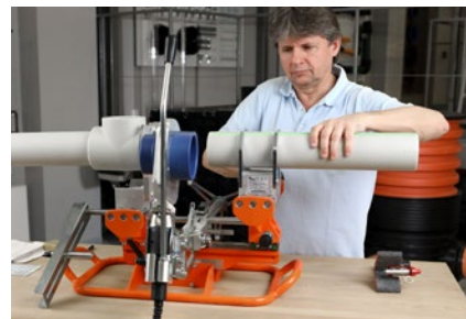
Upnutí do přípravku a vycentrování, poté nahřívání
