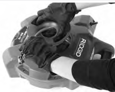
Obrázok 7C – Prestrečenie kábla cez otvor v kryte Obrázok 7 – Vytiahnutie reťazového klopädla z bubna
