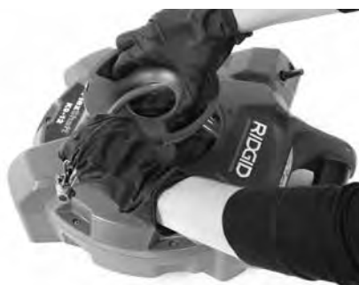
Obrázek 7C – Kabel protáhněte otvorem ve víčku kabelu
