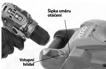
Obrázek 4 – Připojení vrtačky k vstupní hřídeli
