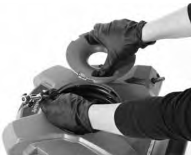
Obrázok 7B – Vytiahnutie reťazového klopädla/kábla
