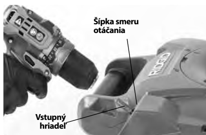
Obrázok 4 – Pripevnenie vrtáčky k vstupnému hriadeľu
