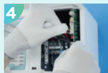
Odpojte kabelové konektory
