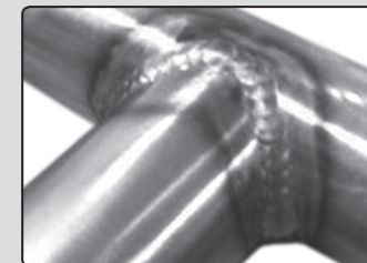
Obr. 6. Rúrky z nehrdzavejúcej ocele zvarené metódou TIG
