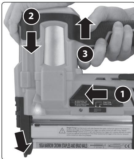
Obr. 4, režim jednorázového nastřelování (selektivního kontaktního spouštění)
