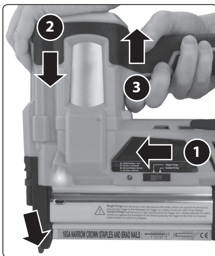
4. ábra. Egyszeri szögbelövés (szelektív, érintős belövés) üzemmód.
