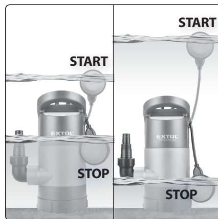
Obr.4, ilustrace funkce plovákového spínače
