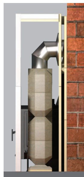
Řez trojvrstvou konstrukcí zadní stěny
